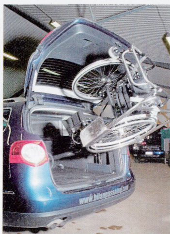
En så kallad bagagerumsrobot lyfter in en rullstol som den hämtat vid förardörren.
